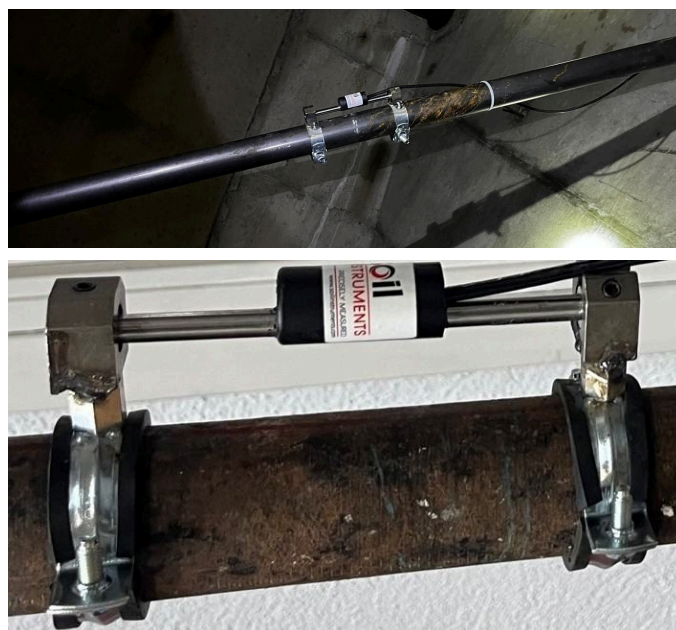
Figura 3. Extensómetros de cuerda vibrante instalados en los puntales..
